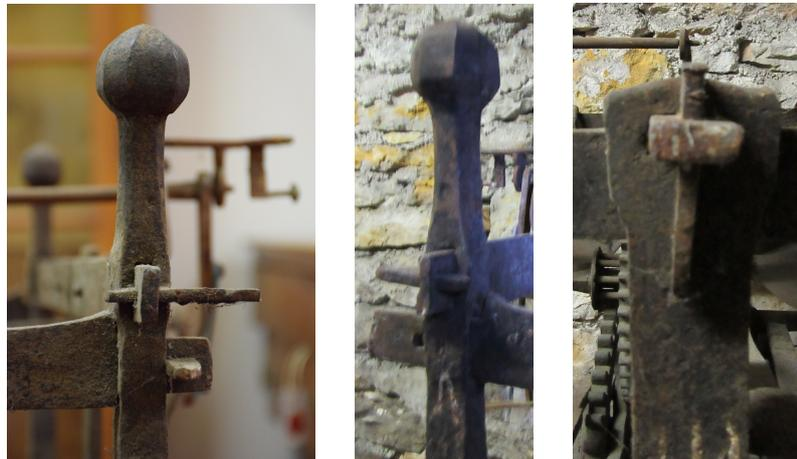
Assemblages forgés, pommeaux et clavettes (horloge de Mende).
